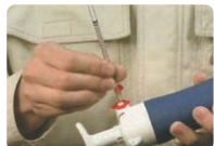
検知管の両端を、チップカッターで折ります。
