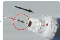
取付口に差し込みます。検知管の向きに注意してください。
